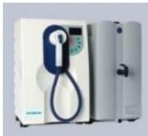
Система Evoqua Ultra Clear TWF включает в себя обратноосмотическую обработку с накопительным баком 30 л и стандартную систему Ultra Clear. Прибор может быть подключен к водопроводу и давать на выходе воду для любых лабораторных применений. Система Ultra Clear TWF UV UF дополнена УФ-окислительным модулем и ультрафильтрационным модулем.
