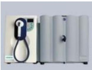
Система Evoqua Ultra Clear TWF включает в себя обратноосмотическую обработку с накопительным баком 60 л и стандартную систему Ultra Clear. Прибор может быть подключен к водопроводу и давать на выходе воду для любых лабораторных применений. Система Ultra Clear TWF UV TM дополнена УФ-окислительным модулем и ТОС-монитором.
