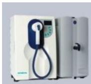
Системы Evoqua содержат все блоки для получения чистой и ультрачистой воды из водопроводной. Вода после обратноосмотического модуля и электро-деионизационного модуля (проводимость ~0,06 мкСм/см) накапливается в накопительном баке. Дальнейшая очистка позволяет получать воду типа I с содержанием ТОС менее 1 ppb. Система дополнена ультрафильтрационным модулем, УФ-окислительным модулем, ТОС-монитором и накопительным баком 30 л.
